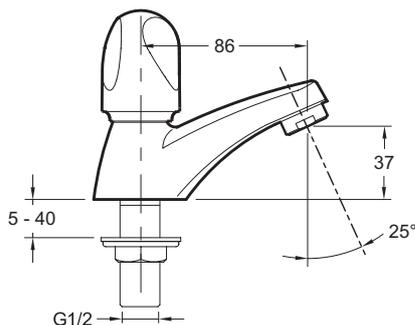
Descriptif CCTP : Robinet indépendant (eau froide). E72922. Collection : GALÉO CD. MATÉRIAU : N/A. TYPE D'INSTALLATION : 1 trou. NORMES ET RÉGLEMENTATIONS : NF : II - EAU : E1 A1 U3 - ACS : 15ACCLY265. DÉBIT (L/MN SOUS 3 BARS) : 10 l/mn. SAILLIE DU BEC (MM) : 86. MÉCANISME : Têtes à disques céramique. NOUVEAUTÉ : 0. Poignée eau froide en métal.
