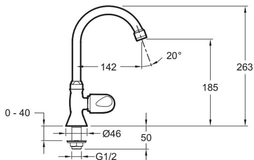
Descriptif CCTP : Robinet indépendant (eau froide). E72967. Collection : GALÉO CD. MATÉRIAU : Métal. TYPE D'INSTALLATION : 1 trou. NORMES ET RÉGLEMENTATIONS : NF : I - EAU : E1 A1 U3 - ACS : 15ACCLY265. DÉBIT (L/MN SOUS 3 BARS) : 10 l/mn. HAUTEUR TOTALE DU ROBINET (MM) : 263. SAILLIE DU BEC (MM) : 142. MÉCANISME : Têtes à disques céramique. NOUVEAUTÉ : 0.
