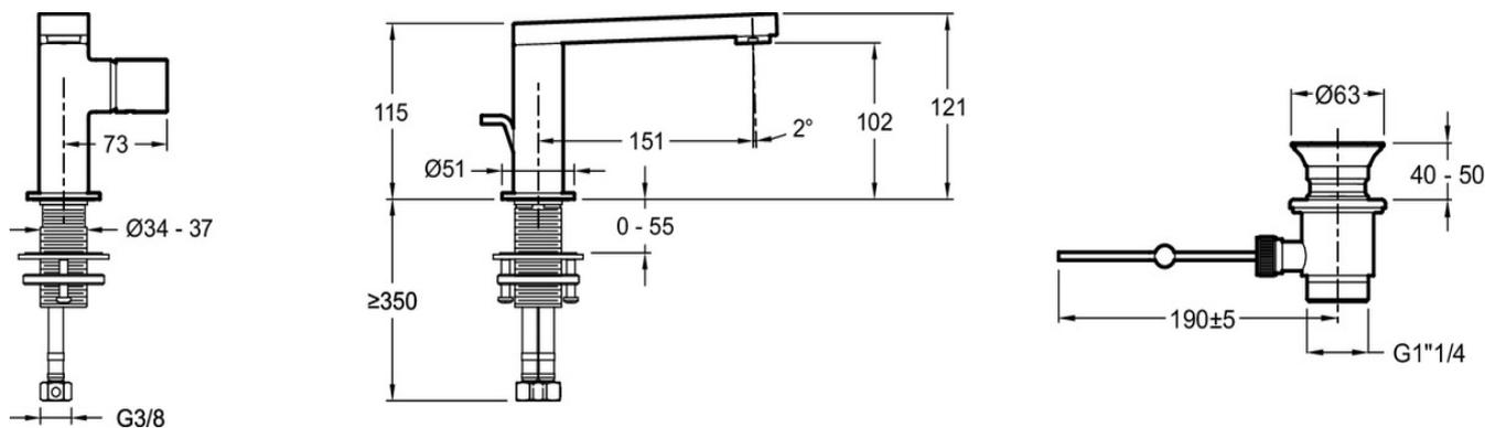
Descriptif CCTP : Mitigeur lavabo - levier "Pure". E73050. Collection : COMPOSED. POIDS : 2,5 kg. MATÉRIAU : Métal. TYPE D'INSTALLATION : 1 trou. NORMES ET RÉGLEMENTATIONS : ACS : 14 ACC LY 511. TYPE : Mitigeur. DÉBIT (L/MN SOUS 3 BAR) : 5 l/mn. HAUTEUR TOTALE DU ROBINET (MM) : 121. SAILLIE DU BEC (MM) : 151. RACCORDS : Avec flexibles d'alimentation. MÉCANISME : Cartouche à disques céramique. Aérateur anti-calcaire..
