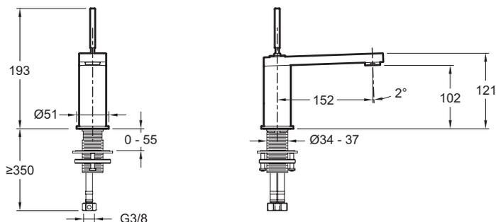
Descriptif CCTP : Mitigeur lavabo - levier "Joystick". E73158-ND. Collection : COMPOSED. POIDS : 2 kg. MATÉRIAU : Métal. TYPE D'INSTALLATION : 1 trou. NORMES ET RÉGLEMENTATIONS : ACS : 14 ACC LY 511. TYPE : Mitigeur. DÉBIT (L/MN SOUS 3 BARS) : 5 l/mn. HAUTEUR TOTALE DU ROBINET (MM) : 121. SAILLIE DU BEC (MM) : 181. RACCORDS : Avec flexibles d'alimentation. MÉCANISME : Cartouche à disques céramique. Sans tirette, sans vidage..Aérateur anti-calcaire..
