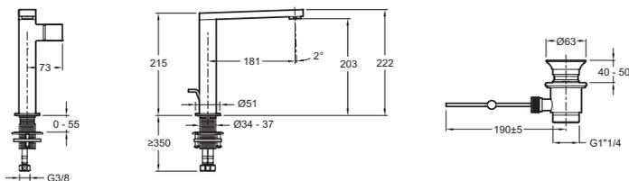
Descriptif CCTP : Mitigeur lavabo - modèle Haut - levier "Pure". E73159. Collection : COMPOSED. POIDS : 3,5 kg. MATÉRIAU : Métal. TYPE D'INSTALLATION : 1 trou. NORMES ET RÉGLEMENTATIONS : ACS : 14 ACC LY 511. TYPE : Mitigeur. DÉBIT (L/MN SOUS 3 BARS) : 5 l/mn. HAUTEUR TOTALE DU ROBINET (MM) : 222. SAILLIE DU BEC (MM) : 181. RACCORDS : Avec flexibles d'alimentation. MÉCANISME : Cartouche à disques céramique. Aérateur anti-calcaire..
