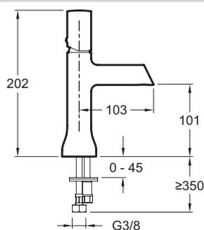
Descriptif CCTP : Mitigeur lavabo. E7329. Collection : TOOBI. POIDS : 1,3 kg. MATÉRIAU : Métal. TYPE D'INSTALLATION : 1 trou. TYPE : Mitigeur. DÉBIT (L/MN SOUS 3 BARS) : 8 l/mn. RACCORDS : Avec flexibles d'alimentation. MÉCANISME : Cartouche à disques céramique. Débit limité à 8 l/mn. Sans bonde de vidage.
