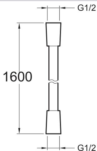
Descriptif CCTP : Flexible 160 cm. E75206. Collection : Hors collection. DIMENSIONS : 160 x cm. POIDS : 1 kg. MATÉRIAU : Métal. NORMES ET RÉGLEMENTATIONS : NF. 1 écrou tournant - 1 écrou droit.
