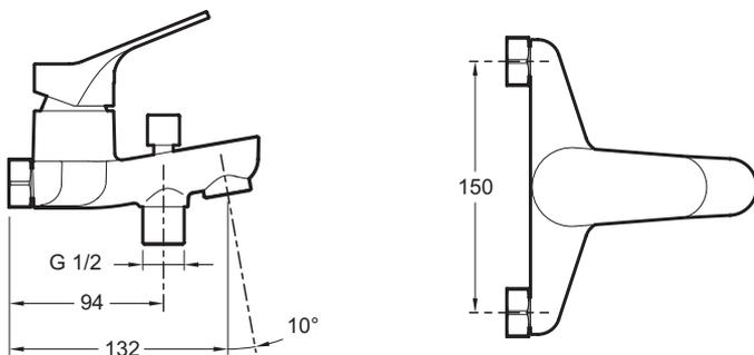
Descriptif CCTP : Mitigeur bain-douche, sans raccords. E75767. Collection : BRIVE. POIDS : 1,3 kg. MATÉRIAU : N/A. TYPE D'INSTALLATION : Mural. NORMES ET RÉGLEMENTATIONS : NF : ID/A - ECAU : E3/1 C2 A2 U3 (Ge3) - ACS : 15 ACC LY 472. TYPE : Mitigeur. DÉBIT (L/MN SOUS 3 BARS) : 21 l/mn. SAILLIE DU BEC (MM) : 132. RACCORDS : Sans raccords. MÉCANISME : Cartouche à disques céramique. ENTRAXE (MM) : 150. NOUVEAUTÉ : 0. Débit : 21 l/mn. Aérateur anti-calcaire.. Clapet anti-retour sur sortie douche..
