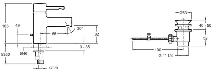
Descriptif CCTP : Mitigeur lavabo - modèle Medium - cartouche C3. E77308. Collection : CÜFF. MATÉRIAU : Métal. TYPE D'INSTALLATION : 1 trou. NORMES ET RÉGLEMENTATIONS : NF : I - ECAU E0 C3 A2 U3 (Ge5) - ACS : 10 ACC LY 113. TYPE : Mitigeur. DÉBIT (L/MN SOUS 3 BARS) : 10 l/mn. HAUTEUR TOTALE DU ROBINET (MM) : 163. SAILLIE DU BEC (MM) : 99. RACCORDS : Avec flexibles d'alimentation. MÉCANISME : Cartouche C3 pour économies d'eau et d'énergie. Bonde de vidage en métal.
