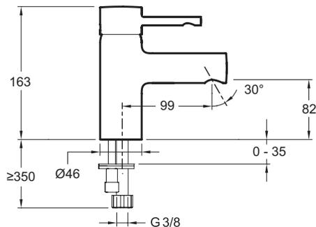
Descriptif CCTP : Mitigeur lavabo - modèle Medium - cartouche C3. E77309. Collection : CÜFF. MATÉRIAU : N/A. NORMES ET RÉGLEMENTATIONS : NF : I - ECAU E0 C3 A2 U3 (Ge5) - ACS : 10 ACC LY 113. TYPE : Mitigeur. DÉBIT (L/MN SOUS 3 BARS) : 10 l/mn. HAUTEUR TOTALE DU ROBINET (MM) : 163. SAILLIE DU BEC (MM) : 99. MÉCANISME : Cartouche C3 pour économies d'eau et d'énergie. Sans bonde de vidage. Corps lisse, sans tirette.
