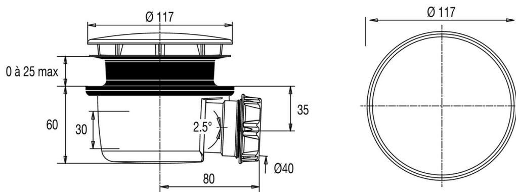
Descriptif CCTP : Bonde extra-plate NF avec capot. E78171-F. Collection : Hors collection. DIMENSIONS : 14 x 9 x 6 cm. POIDS : 0,3 kg. MATÉRIAU : N/A. TYPE D'INSTALLATION : Posé. ANTIDÉRAPANT : Non. DIAMÈTRE DE BONDE (CM) : 9. DURÉE GARANTIE (ANNÉES) : 2. Sortie : 40 mm à visser ou à coller.
