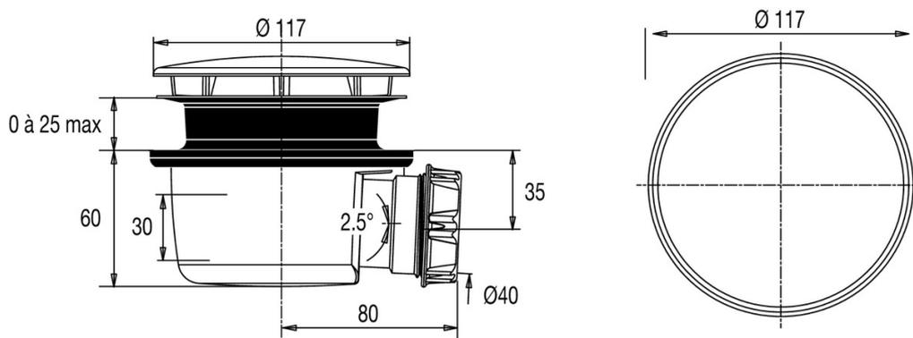
Descriptif CCTP : Bonde extra-plate NF avec capot. E78171. Collection : Hors collection. DIMENSIONS : 14 x 9 x 6 cm. POIDS : 0,3 kg. MATÉRIAU : N/A. TYPE D'INSTALLATION : Posé. ANTIDÉRAPANT : Non. DIAMÈTRE DE BONDE (CM) : 9. DURÉE GARANTIE (ANNÉES) : 2. Débit 28 l/mn. Sortie : 40 mm à visser ou à coller.
