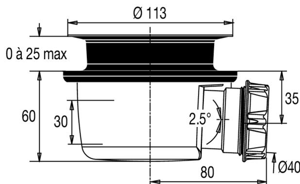
Descriptif CCTP : Bonde extra-plate NF sans capot. E78172. Collection : Hors collection. DIMENSIONS : 14 x 9 x 6 cm. NORMES ET RÉGLEMENTATIONS : NF. ANTIDÉRAPANT : Non. DIAMÈTRE DE BONDE (CM) : 9. Débit 29 L/min mesuré selon la norme NF. Garde d'eau de 30 mm pour éviter les remontées d'odeurs. Bonde standard diamètre 90 mm compatible avec tous les receveurs livrés avec capot et notamment Singulier et Flight Neus.
