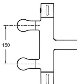
Descriptif CCTP : Mitigeur thermostatique bain-douche sur gorge. E78521. Collection : CÜFF. MATÉRIAU : N/A. TYPE D'INSTALLATION : 2 trous. NORMES ET RÉGLEMENTATIONS : NF : II\*/A - ECAU : E3/1C3A1U3 - ACS : 10 ACC LY 103. TYPE : Mitigeur. DÉBIT (L/MN SOUS 3 BARS) : 20 l/mn. RACCORDS : Avec raccords colonnettes. MÉCANISME : Cartouche thermostatique. Corps tiède : fonderie compartimentée.
