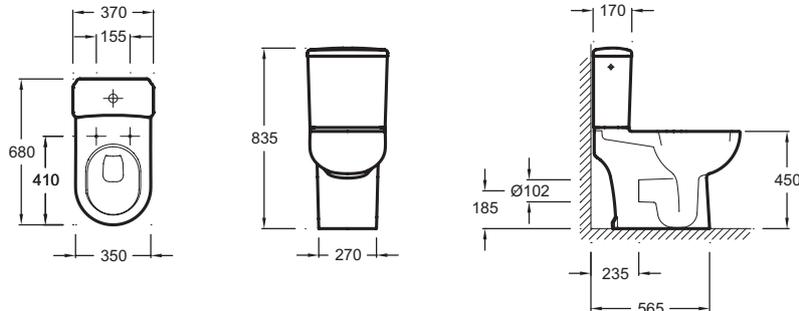
Descriptif CCTP : Pack WC au sol surélevé PMR, sortie vario. E8353. Collection : ODÉON. DIMENSIONS : 68 x 35 cm. POIDS : 44,2 kg. MATÉRIAU : Céramique. TYPE D'INSTALLATION : Au sol. NORMES ET RÉGLEMENTATIONS : NF. CONSOMMATION D'EAU : Standard 3/6 L. HAUTEUR : Surélevée/PMR. TYPE DE BRIDE : Ouverte (traditionnelle). LIVRÉ AVEC : Abattant thermodur E4750 ; 2 kits de fixation au sol.
