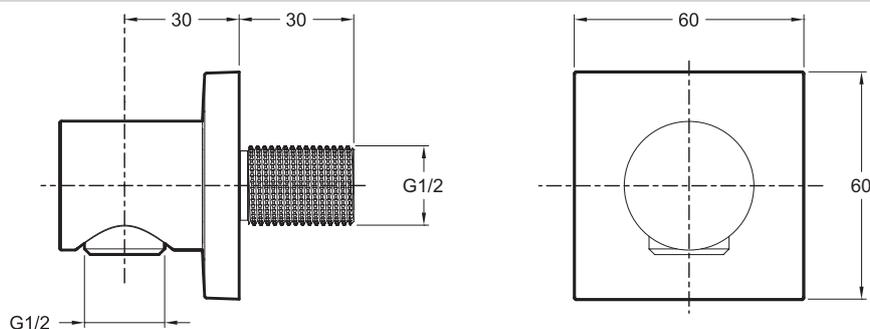
Descriptif CCTP : Coude de raccordement - rosace Square. E8467. Collection : MODULO. DIMENSIONS : 13,50 x 9 x 6,50 cm. POIDS : 0,5 kg. MATÉRIAU : Métal. TYPE D'INSTALLATION : Mural. TYPE D'ACCESSOIRE : Coude de raccordement. DESIGN DE ROBINETTERIE DE DOUCHE : CONTEMPORAIN CARRÉ. Avec clapet anti-retour.
