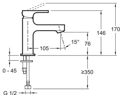
Descriptif CCTP : Mitigeur lavabo - modèle standard, sans vidage. E8919. Collection : STRAYT. POIDS : 1,4 kg. MATÉRIAU : Métal. TYPE D'INSTALLATION : 1 trou. NORMES ET RÉGLEMENTATIONS : ACS : 14 ACC LY 511. TYPE : Mitigeur. DÉBIT (L/MN SOUS 3 BARS) : 5 l/mn. HAUTEUR TOTALE DU ROBINET (MM) : 146. SAILLIE DU BEC (MM) : 105. RACCORDS : Avec flexibles d'alimentation. MÉCANISME : Cartouche à disques céramique. Corps lisse, sans tirette, sans vidage. Aérateur anti-calcaire.
