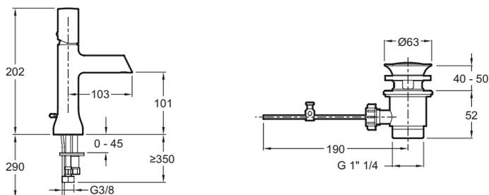
Descriptif CCTP : Mitigeur lavabo avec flexibles d'alimentation. E8959. Collection : TOOBI. POIDS : 1,6 kg. MATÉRIAU : Métal. TYPE D'INSTALLATION : 1 trou. NORMES ET RÉGLEMENTATIONS : ACS : 14 ACC LY 511. TYPE : Mitigeur. DÉBIT (L/MN SOUS 3 BARS) : 8 l/mn. HAUTEUR TOTALE DU ROBINET (MM) : 101. SAILLIE DU BEC (MM) : 103. RACCORDS : Avec flexibles d'alimentation. MÉCANISME : Cartouche à disques céramique. Tirette latérale.
