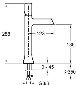
Descriptif CCTP : Mitigeur lavabo - modèle haut. E8960. Collection : TOOBI. POIDS : 1,7 kg. MATÉRIAU : N/A. TYPE D'INSTALLATION : 1 trou. TYPE : Mitigeur. DÉBIT (L/MN SOUS 3 BARS) : 8. HAUTEUR TOTALE DU ROBINET (MM) : 186. SAILLIE DU BEC (MM) : 123. RACCORDS : Avec flexibles d'alimentation. MÉCANISME : Cartouche à disques céramique. sans tirette.
