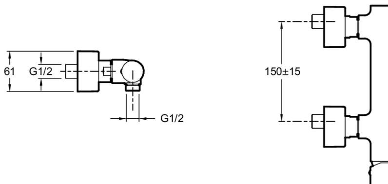
Descriptif CCTP : Mitigeur douche mural. E8962. Collection : T00BI. POIDS : 1,7 kg. MATÉRIAU : Métal. TYPE D'INSTALLATION : Mural. TYPE : Mitigeur. DÉBIT (L/MN SOUS 3 BAR) : 12 l/mn. RACCORDS : Avec raccords et rosaces murales. MÉCANISME : Cartouche à disques céramique. ENTRAXE (MM) : 150 ± 15.
