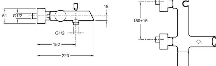
Descriptif CCTP : Mitigeur bain-douche mural. E8963. Collection : TOOBI. POIDS : 2,6 kg. MATÉRIAU : N/A. TYPE D'INSTALLATION : 2 trous. TYPE : Mitigeur. RACCORDS : Avec raccords et rosaces murales. MÉCANISME : Cartouche à disques céramique.
