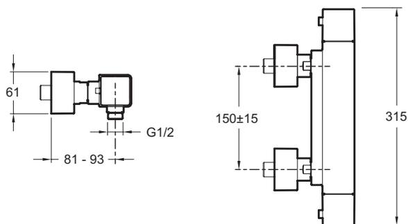
Descriptif CCTP : Mitigeur thermostatique douche mural. E9096. Collection : STRAYT. POIDS : 3,1 kg. MATÉRIAU : Métal. TYPE D'INSTALLATION : 2 trous. TYPE : Mitigeur. DÉBIT (L/MN SOUS 3 BARS) : 13 l/mn. RACCORDS : Avec raccords et rosaces murales. MÉCANISME : Cartouche thermostatique. ENTRAXE (MM) : 150 ± 15.
