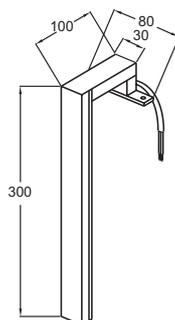
Descriptif CCTP : Spot LED "Segment" 30 cm. EB1218. Collection : Hors collection. DIMENSIONS : 8 x 10 x 30 cm. POIDS : 1 kg. MATÉRIAU : Métal. TYPE D'INSTALLATION : Mural. ÉLECTRICITÉ : 220V, 4W, Classe II IP44.
