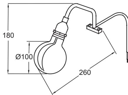
Descriptif CCTP : Spot LED "Industrie fixe". EB1242. Collection : Hors collection. DIMENSIONS : 30 x 26 x 30 cm. POIDS : 1 kg. MATÉRIAU : Métal. TYPE D'INSTALLATION : Mural. ÉLECTRICITÉ : 240V, 9W, Classe II IP44, Culot E27.
