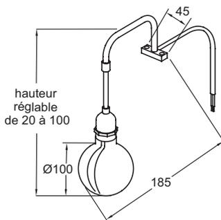
Descriptif CCTP : Spot LED "Industrie suspendue". EB1278. Collection : Hors collection. DIMENSIONS : 30 x 9,20 x 30 cm. POIDS : 1 kg. MATÉRIAU : Métal. TYPE D'INSTALLATION : Mural. ÉLECTRICITÉ : 240V, 9W, Classe II IP44, Culot E27.
