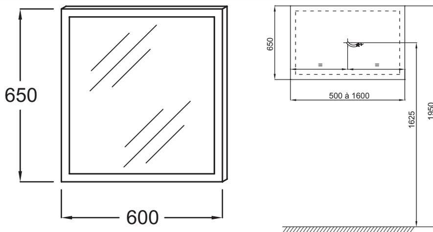
Descriptif CCTP : Miroir Liseré 60 cm. EB1440. Collection : Hors collection. DIMENSIONS : 60 x 4,30 x 65 cm. POIDS : 7 kg. MATÉRIAU : Verre. TYPE D'INSTALLATION : Mural. RANGEMENT : Miroir. ÉLECTRICITÉ : 230V, 10W, classe II IP44. LUMIÈRE : Oui. PRISE ÉLECTRIQUE : Non. PRISE USB : Non. ANTIBUÉE : Oui. HORLOGE : Non.
