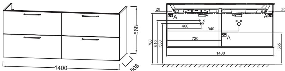
Descriptif CCTP : Meuble sous plan-vasque 140 cm - 4 tiroirs. EB2526-R9. Collection : ODÉON RIVE GAUCHE. DIMENSIONS : 140 x 50,80 x 56,80 cm. POIDS : 57,8 kg. MATÉRIAU : Laque ou mélaminé. TYPE D'INSTALLATION : Suspendu. NORMES ET RÉGLEMENTATIONS : NF. RANGEMENT : Meuble sous plan-vasque.
