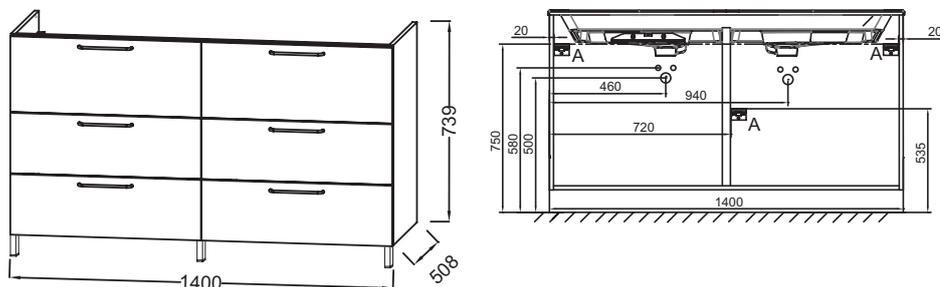
Descriptif CCTP : Meuble sous plan-vasque 140 cm - 6 tiroirs. EB2536-R9. Collection : ODÉON RIVE GAUCHE. DIMENSIONS : 140 x 50,80 x 73,90 cm. POIDS : 78,2 kg. MATÉRIAU : Laque ou mélaminé. TYPE D'INSTALLATION : Suspendu. NORMES ET RÉGLEMENTATIONS : NF. RANGEMENT : Meuble sous plan-vasque.
