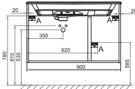
Descriptif CCTP : Meuble sous plan-vasque 90 cm - 2 tiroirs/1 porte. EB2543-R7. Collection : ODÉON RIVE GAUCHE. DIMENSIONS : 90 x 50,80 x 56,80 cm. POIDS : 39,4 kg. MATÉRIAU : Laque ou mélaminé. TYPE D'INSTALLATION : Suspendu. NORMES ET RÉGLEMENTATIONS : NF. RANGEMENT : Meuble sous plan-vasque.
