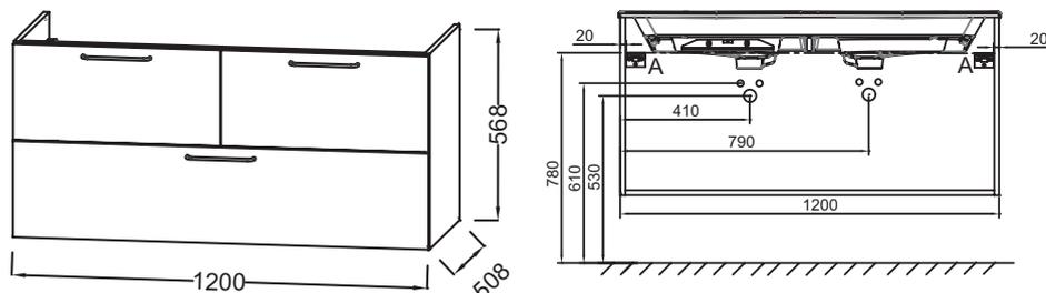
Descriptif CCTP : Meuble sous plan-vasque 120 cm - 3 tiroirs. EB2545-R7. Collection : ODÉON RIVE GAUCHE. DIMENSIONS : 120 x 50,80 x 56,80 cm. POIDS : 50,5 kg. MATÉRIAU : Laque ou mélaminé. TYPE D'INSTALLATION : Suspendu. NORMES ET RÉGLEMENTATIONS : NF. RANGEMENT : Meuble sous plan-vasque.
