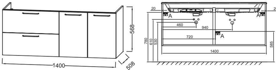
Descriptif CCTP : Meuble sous plan-vasque 140 cm - 2 tiroirs/2 portes. EB2546-R5. Collection : ODÉON RIVE GAUCHE. DIMENSIONS : 140 x 50,80 x 56,80 cm. POIDS : 49 kg. MATÉRIAU : Laque ou mélaminé. TYPE D'INSTALLATION : Suspendu. NORMES ET RÉGLEMENTATIONS : NF. RANGEMENT : Meuble sous plan-vasque.
