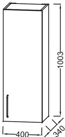
Descriptif CCTP : Demi-colonne 40 cm, droite. EB2571D-R9. Collection : ODÉON RIVE GAUCHE. DIMENSIONS : 40 x 34 x 100 cm. POIDS : 18,5 kg. MATÉRIAU : Laque ou mélaminé. TYPE D'INSTALLATION : Suspendu. NORMES ET RÉGLEMENTATIONS : NF. RANGEMENT : Colonne.
