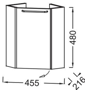
Descriptif CCTP : Meuble sous lave-mains 46 cm, gauche. EB2584G-R8. Collection : ODÉON RIVE GAUCHE. DIMENSIONS : 45,50 x 21,60 x 48 cm. POIDS : 11,5 kg. MATÉRIAU : Laque ou mélaminé. TYPE D'INSTALLATION : Suspendu.
