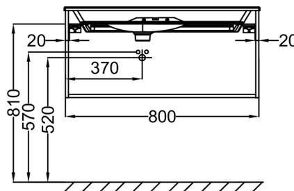
Descriptif CCTP : Meuble sous plan-vasque 80 cm - 2 tiroirs. EB3030. Collection : NOUVELLE VAGUE. DIMENSIONS : 80 x 50,70 x 45,50 cm. POIDS : 31,5 kg. MATÉRIAU : Laque ou mélaminé. TYPE D'INSTALLATION : Suspendu.
