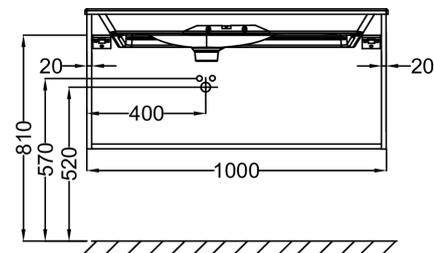
Descriptif CCTP : Meuble sous plan-vasque 100 cm - 2 tiroirs. EB3032. Collection : NOUVELLE VAGUE. DIMENSIONS : 100 x 50,70 x 45,50 cm. POIDS : 35 kg. MATÉRIAU : Laque ou mélaminé. TYPE D'INSTALLATION : Suspendu.
