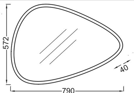
Descriptif CCTP : Miroir 79 cm LED. EB3049. Collection : NOUVELLE VAGUE. DIMENSIONS : 79 x 57,20 x 4 cm. POIDS : 10 kg. MATÉRIAU : Verre. TYPE D'INSTALLATION : Mural. ÉLECTRICITÉ : 230V, 44W, classe II IP44.
