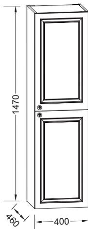
Descriptif CCTP : Colonne 40 cm, droite. EB732D. Collection : CLÉO 1889. DIMENSIONS : 40 x 46 x 147 cm. MATÉRIAU : Laque. TYPE D'INSTALLATION : Suspendu.
