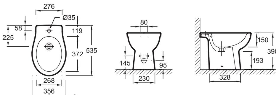
Descriptif CCTP : Bidet au sol. EBB0001. Collection : PATIO. DIMENSIONS : 54 x 36 cm. POIDS : 18,8 kg. MATÉRIAU : Céramique. TYPE D'INSTALLATION : Au sol. HAUTEUR : Standard. Percé 1 trou de robinetterie.
