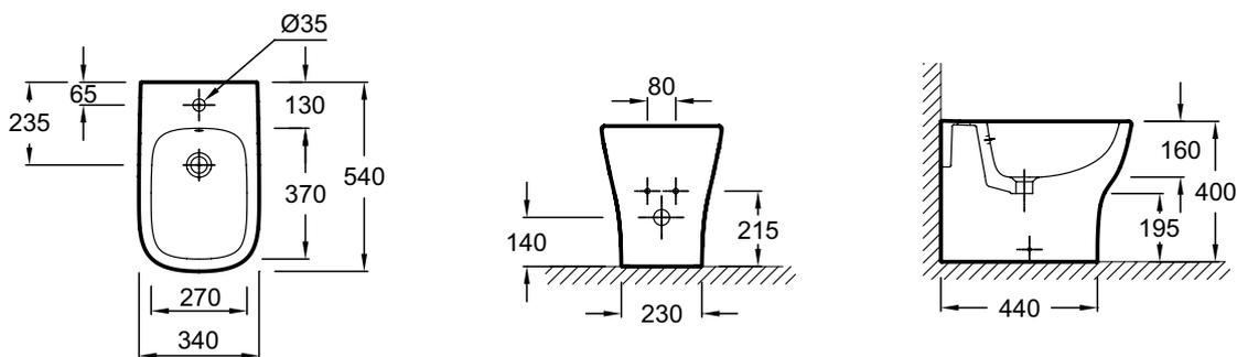
Descriptif CCTP : Bidet au sol. EBH0001. Collection : STRUKTURA. DIMENSIONS : 54 x 34 cm. POIDS : 23,5 kg. MATÉRIAU : Céramique. TYPE D'INSTALLATION : Au sol. HAUTEUR : Standard. TYPE DE BRIDE : Sans bride. Percé 1 trou, sans cache du trou de trop-plein.
