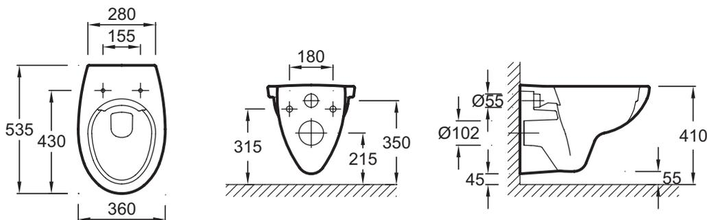
Descriptif CCTP : Pack WC suspendu SANS BRIDE. EDV134. Collection : PATIO. DIMENSIONS : 53,50 x 36 cm. POIDS : 15 kg. MATÉRIAU : Céramique. TYPE D'INSTALLATION : Suspendu. CONSOMMATION D'EAU : Standard 3/6 L. HAUTEUR : Standard. TYPE DE BRIDE : Sans bride. LIVRÉ AVEC : Abattant thermodor extra-plat à descendre progressive et déclinable, charnières métal E23157-00.
