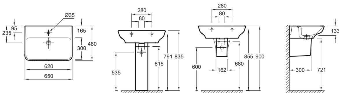
Descriptif CCTP : Lavabo 65 cm, non meulé. EGC111. Collection : STRUKTURA. DIMENSIONS : 65 x 48 cm. POIDS : 18,5 kg. MATÉRIAU : Céramique. TYPE D'INSTALLATION : Autoportant. NORMES ET RÉGLEMENTATIONS : NF.
