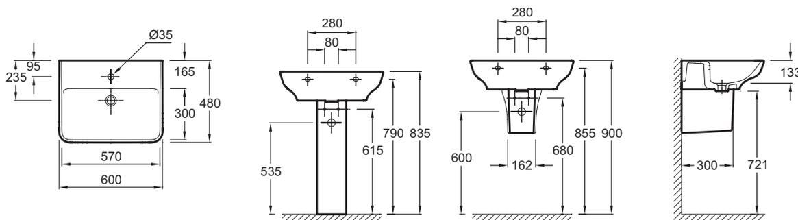
Descriptif CCTP : Lavabo 60 cm, non meulé. EGD111. Collection : STRUKTURA. DIMENSIONS : 60 x 48 cm. POIDS : 18 kg. MATÉRIAU : Céramique. TYPE D'INSTALLATION : Autoportant. NORMES ET RÉGLEMENTATIONS : NF.
