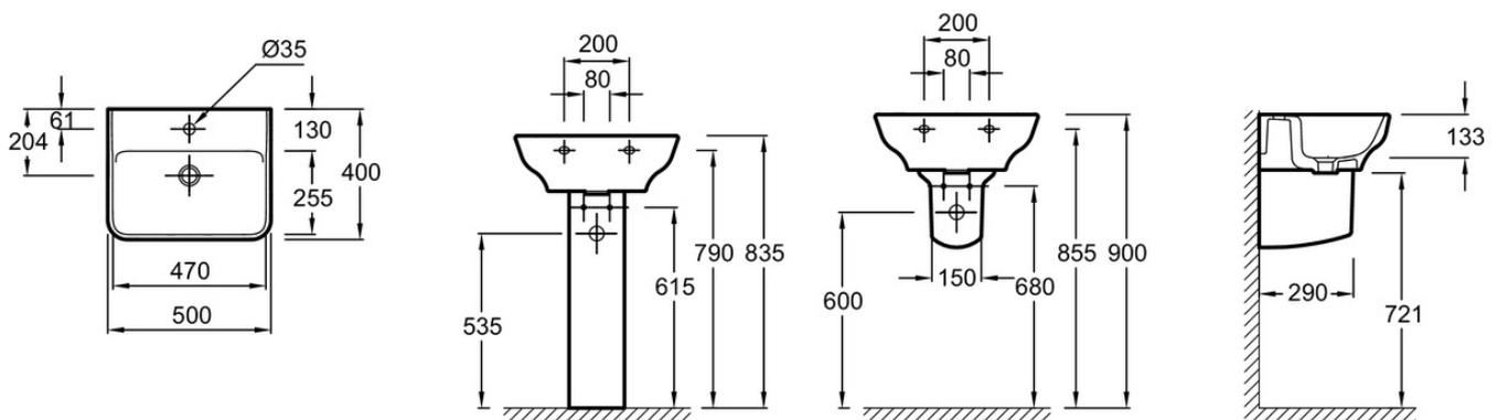
Descriptif CCTP : Lavabo 50 cm, non meulé. EGF011. Collection : STRUKTURA. DIMENSIONS : 50 x 40 cm. POIDS : 13,6 kg. MATÉRIAU : Céramique. TYPED'INSTALLATION : Autoportant. DURÉE GARANTIE (ANNÉES) : 10.
