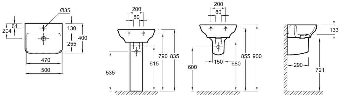
Descriptif CCTP : Lavabo 50 cm, non meulé. EGF111. Collection : STRUKTURA. DIMENSIONS : 50 x 40 cm. POIDS : 13,6 kg. MATÉRIAU : Céramique. TYPE D'INSTALLATION : Autoportant.
