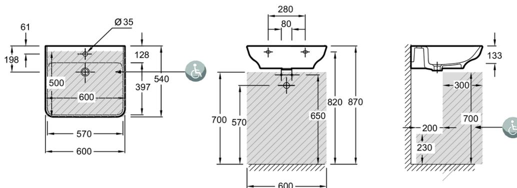
Descriptif CCTP : Lavabo PMR 60 cm, non meulé. EGG011. Collection : STRUKTURA. DIMENSIONS : 60 x 54 cm. POIDS : 19,6 kg. MATÉRIAU : Céramique. TYPE D'INSTALLATION : Autoportant. DURÉE GARANTIE (ANNÉES) : 10.
