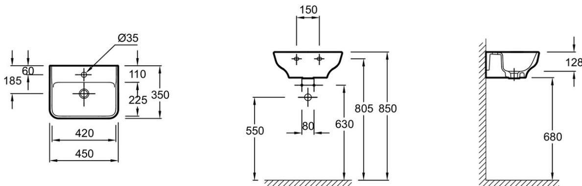
Descriptif CCTP : Lave-mains 45 cm, non meulé. EGH011. Collection : STRUKTURA. DIMENSIONS : 45 x 35 cm. POIDS : 11,8 kg. MATÉRIAU : Céramique. TYPED'INSTALLATION : Autoportant. NORMES ET RÉGLEMENTATIONS : NF. SIPHON RECOMMANDÉ : Non. PERCEMENT ROBINETTERIE : 1 trou. MEULÉ/NON-MEULÉ : A installer avec un meuble. TROP-PLEIN : Sans. DURÉE GARANTIE (ANNÉES) : 10.
