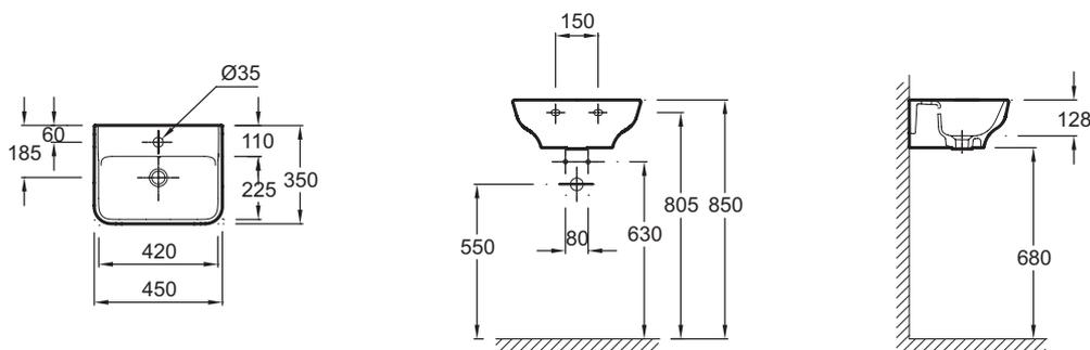
Descriptif CCTP : Lave-mains 45 cm. EGH111. Collection : STRUKTURA. DIMENSIONS : 45 x 35 cm. POIDS : 10 kg. MATÉRIAU : Céramique. TYPE D'INSTALLATION : Autoportant. PERCEMENT ROBINETTERIE : 1 trou. MEULÉ/NON-MEULÉ : A installer avec un meuble. TROP-PLEIN : Avec.
