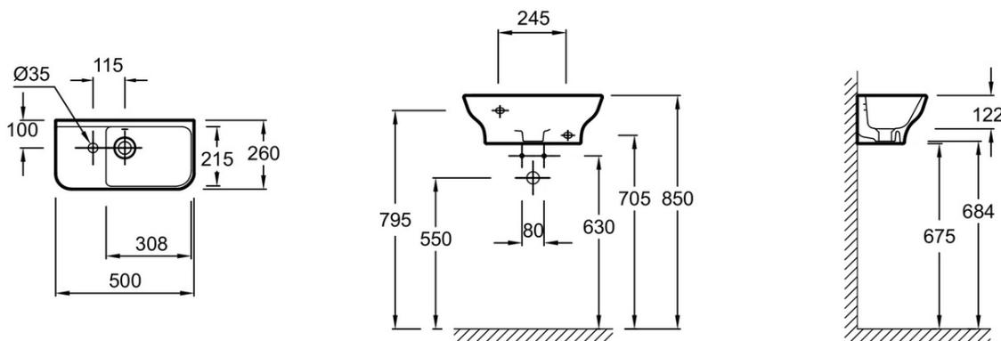
Descriptif CCTP : Lave-mains 50 cm. EGJ111. Collection : STRUKTURA. DIMENSIONS : 50 x 26 cm. POIDS : 10 kg. MATÉRIAU : Céramique. TYPE D'INSTALLATION : Autoportant. DURÉE GARANTIE (ANNÉES) : 10.
