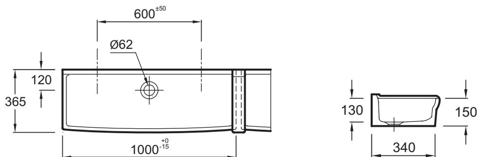
Descriptif CCTP : Lavabo 100 cm. EN290. Collection : DUO. DIMENSIONS : 100 x 36,50 cm. POIDS : 26,5 kg. MATÉRIAU : Céramique. TYPE D'INSTALLATION : Non autoportant, nécessite des supports muraux (non fournis). PERCEMENT ROBINETTERIE : Sans. CONFIGURATION : STANDARD. Lavabo mural en céramique.
