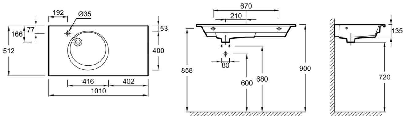
Descriptif CCTP : Plan-vasque 100 cm, meulé. EXAU112-Z. Collection : ODÉON RIVE GAUCHE. DIMENSIONS : 101 x 51,20 cm. POIDS : 28,4 kg. MATÉRIAU : Céramique. TYPED'INSTALLATION : Autoportant ou peut être monté sur un meuble spécifique. DURÉE GARANTIE (ANNÉES) : 10.
